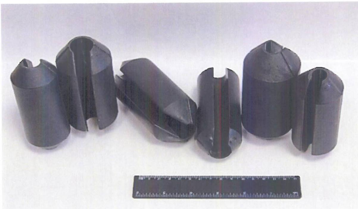
Рисунок 1 – направляющие втулки-центроторы насосных штанг.
